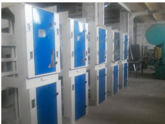
**КСО-298** камера сборная одностороннего обслуживания 200-й серии. Разработка 1998 года. Используется для ввода и распределения электроэнергии 6-10 кВ. Применяется в комплектации КТП, РП и РТП.
