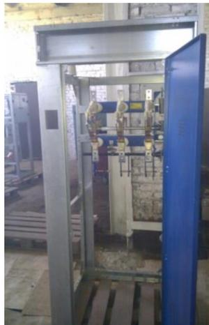
Аппаратура данного типа (ячейки КСО-393) применяется на тупиковых и проходных подстанциях КТП, РТП, в распределительном оборудовании, а также на подстанциях с переменным током не менее 50 Гц и напряжением 6 (10) кВ (в системах, имеющих изолированную нейтраль или глухозаземленную).
