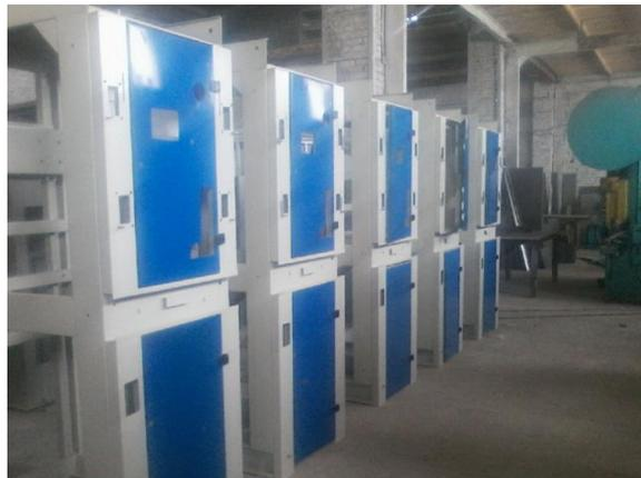
**КСО-205** (модификацией **КСО-203**) используется для комплектования РП и РТП напряжением 6-10 кВ.
